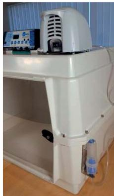
**Figura 2 (derecha):** Incubadora Brinsea Vetario® incubador que permite tratamiento con nebulización
